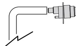
SDP\*: пластмассовая форсунка производительностью до 18 кг/ч
